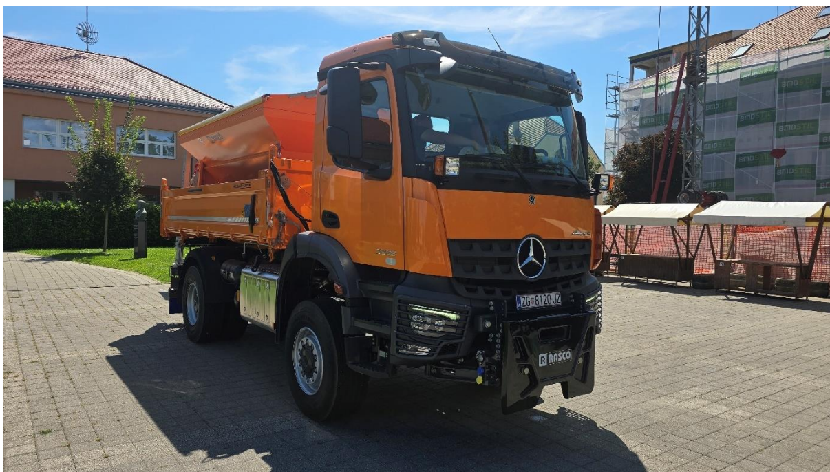
Slika 3. Kamion kiper Mercedes Arocs s opremom za zimsku službu
